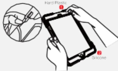
1. Détachez doucement les languettes sur les côtés droit et gauche du boîtier.
